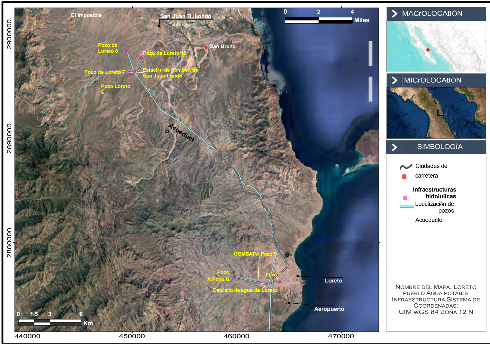
Figura 3. Infraestructura de abastecimiento de agua de la ciudad de Loreto
